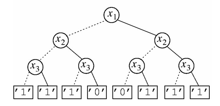
$f = \overline{x_1} \overline{x_2} \overline{x_3} + \overline{x_1} x_2 \overline{x_3} + \overline{x_1} \overline{x_2} x_3 + \overline{x_1} \overline{x_2} x_3 + x_1 \overline{x_2} x_3 + x_1 x_2 \overline{x_3} + x_1 x_2 x_3$
